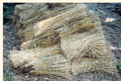
Fascine preparate per la copertura della struttura.
